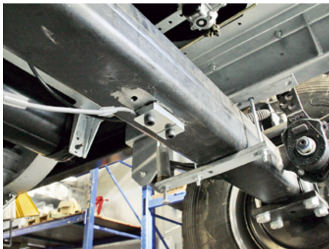
Der Dehnmessstreifen in der Achsenmitte erfasst die Achslast und gibt sie an ein Terminal im Schlepper weiter.
