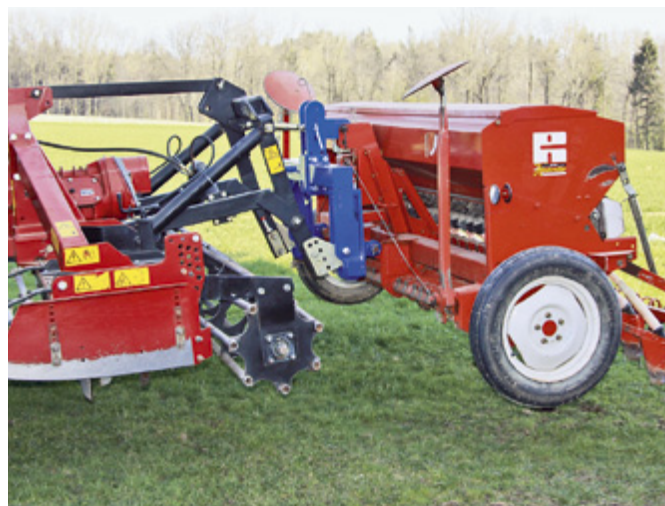
Die Dreipunktwaage ist flexibel einsetzbar. Aber: Das Umrechnen auf die Ausbringmenge muss der Fahrer erledigen.
